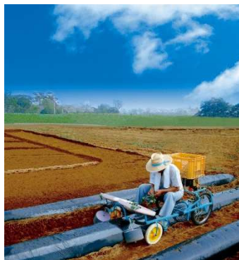
▲2つ折りにたたむと軽トラックの荷台に 2台一度に搭載が可能です。
