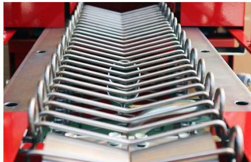
搬送金具のV形状でサツマイモがセンターに集まりやすく、サイドのリングで落下を防止します。
