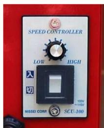
作業速度はダイヤルにより無段階で調整できるので、状況に合わせて作業いただけます。
