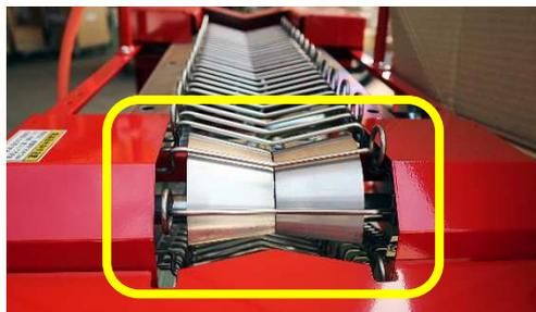
前後補助ガイドの採用で、サツマイモの落込みを防止。
