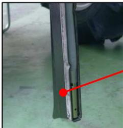
注入刀は、チェック弁付ノズルを採用。旋回時など、土中から抜けても、液を飛散させません。
