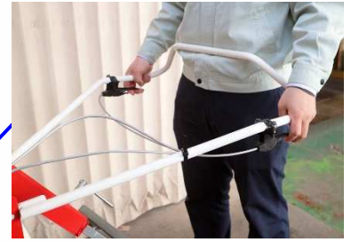
作業時に腹で押して、機械の 前進を補助
