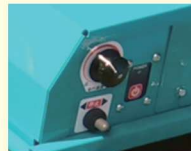
スイッチで前後進切替え。速度調節は、無段階ボリューム式。
