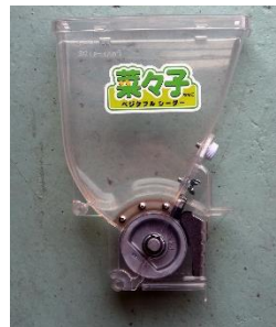
スプロケットと替えギヤーの交換で株間の変更を行います
